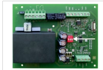
Abb. 8: DIP-Schalter auf der Platine
