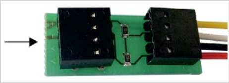
Abb. 15: Platine mit Anschlussklemmen
