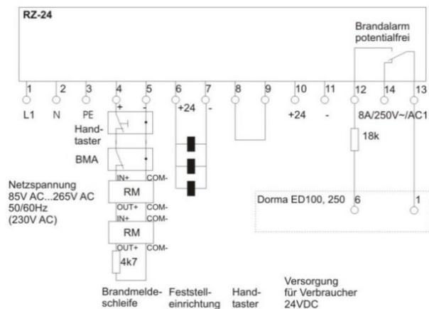
Der Reihenwiderstand 18k dient der Überwachung der Leitung zur Auslösung des Dorma Antriebes und ist im Gehäuse der RZ-24/RZ8 zu installieren.
