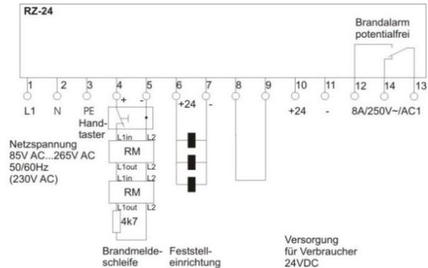
Feststellanlage RZ-24 mit Brandmeldeschleife für Brandmelder Typen z.B.: Apollo Orbis OP 12001, A1R HT-11001, OH-13001 und Auslösung durch Brandmeldeanlage und Drehtürantrieb ED100, 250
