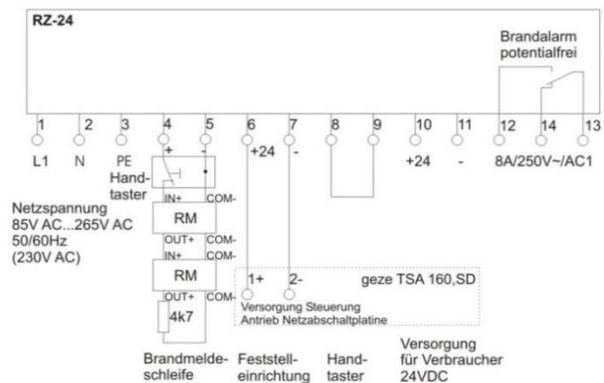
Feststellanlage RZ-24 mit Brandmeldeschleife für Brandmelder Typen z.B.: Apollo Orbis OP 12001, A1R HT-11001, OH-13001 und Türautomatik Schnetz ATS...MOF, MOFE
